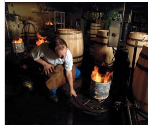
Operario de un taller de la Tonelería Nadalie, en Médoc, supervisando el brasero donde se moldean y tuestan las duelas de madera de roble. Pág. 26.
